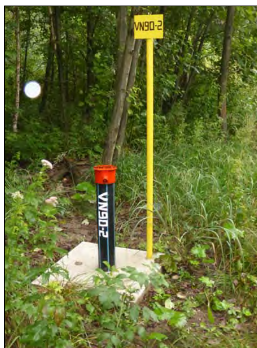
Príklad nového monitorovacieho vrtu VN90-2 na lokalite 90 Banská Štiavnica – odkalisko Lintich
