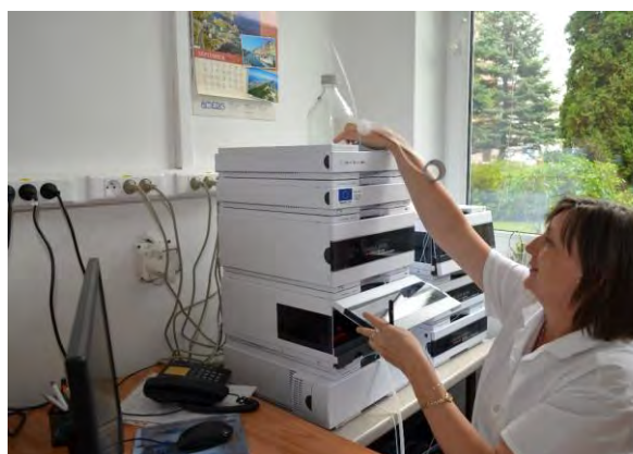
Kvapalinový chromatograf Agilent 1260 Infinity – stanovenie triazínových pesticídov a polyaromatických uhlíkovodíkov v geologických materiáloch, vodách, emisiách a pracovnom ovzduší
