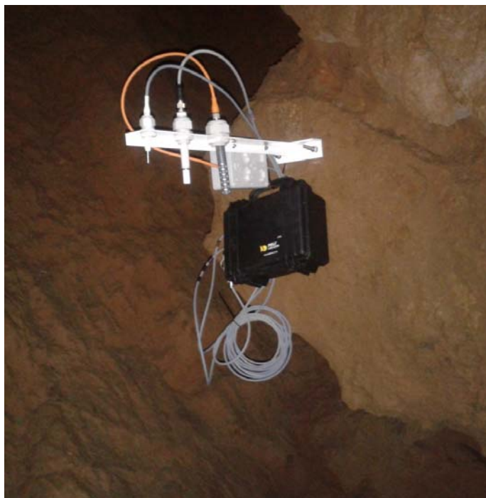
Inštalované monitorovacie zariadenia pre sledovanie parametrov vzduchu v Krásnohorskej jaskyni
