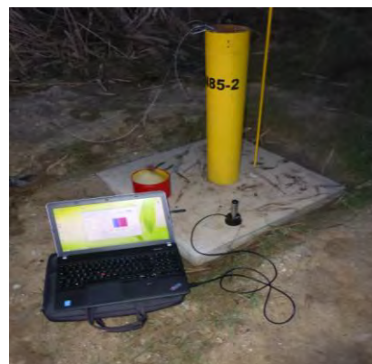
Sťahovanie údajov zo zariadení na kontinuálne zaznamenávanie teploty vody a hladiny podzemnej vody – vrt VN85-2 pod skládkou TKO Bojná
