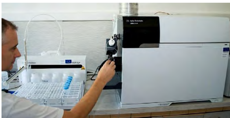
Agilent 7900 ICP MS Optická emisná spektrometria s hmotnostnou detekciou – ICP MS
