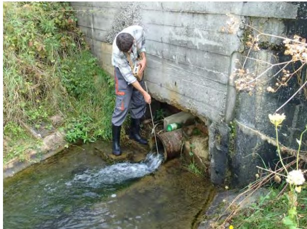
Meranie prietoku na výtoku z Novej odvodňovacej štôlne v rámci projektu ISSOP
