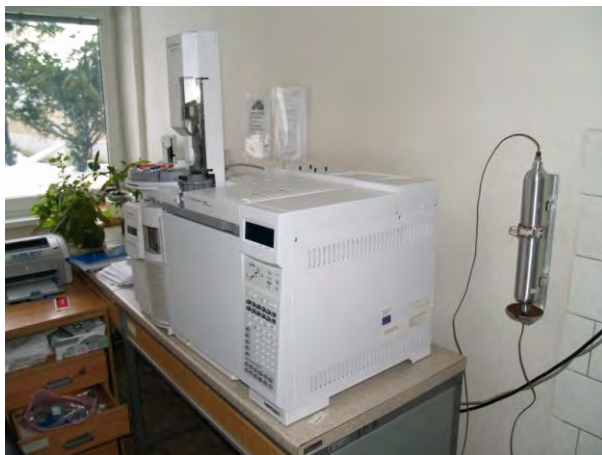
Plynový chromatograf s hmotnostným detektorom na stanovenie organických látok vo vodách a tuhých vzorkách.
