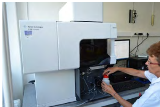
Agilent 5100 ICP-OES Optická emisná spektrometria s indukčne viazanou plazmou
