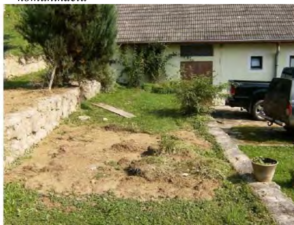
Obec Hrachovište Teleso zemného prúdu bezprostredne po vzniku – okraje (vľavo) a čelo svahovej deformácie (vpravo)
