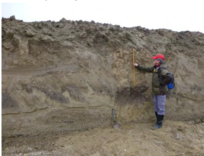
Zameriavanie hĺbky fosilneho pôdneho horizontu (atlantik-subboreál) a príprava pre odber vzorky.
