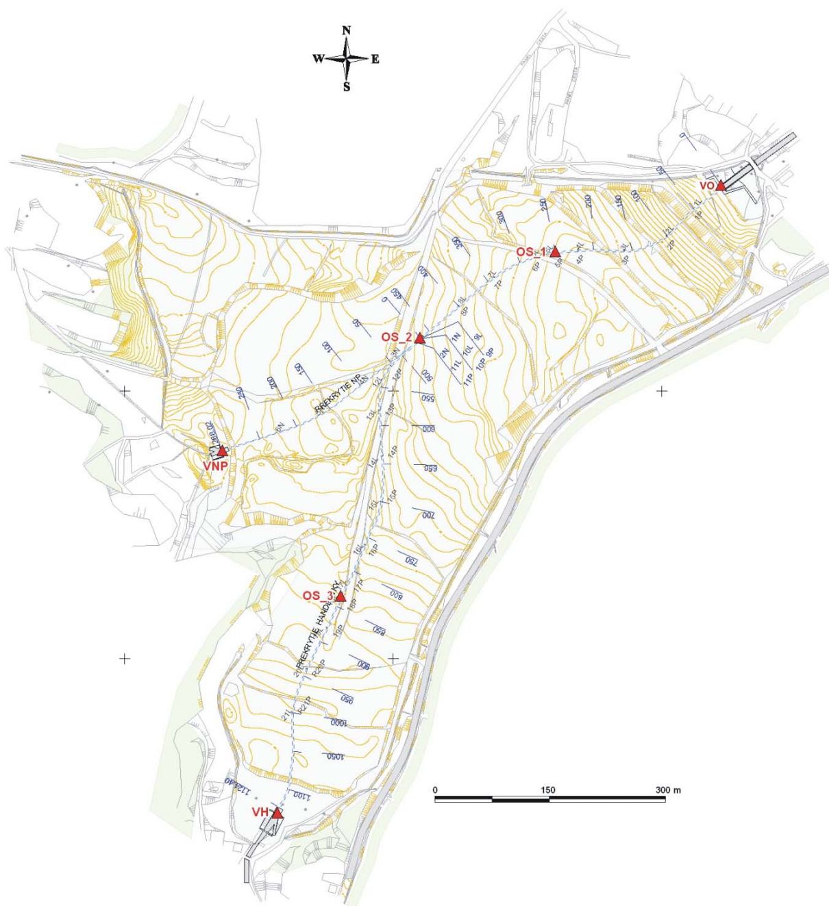
Obr. 1: Lokalita Handlová – Stabilizačný násyp. Situácia indikačných bodov (vyznačené červenou farbou), meracích staníc (L – ľavé potrubie, P – pravé potrubie, N – potrubie Nepomenovaného potoka) a staničenia potrubia (modrou farbou)
