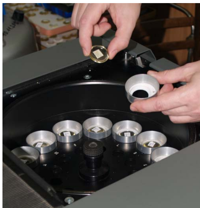
Röntgenovo-fluorescenčná spektrometria na stanovenie makroprvkov a stopových prvkov.
