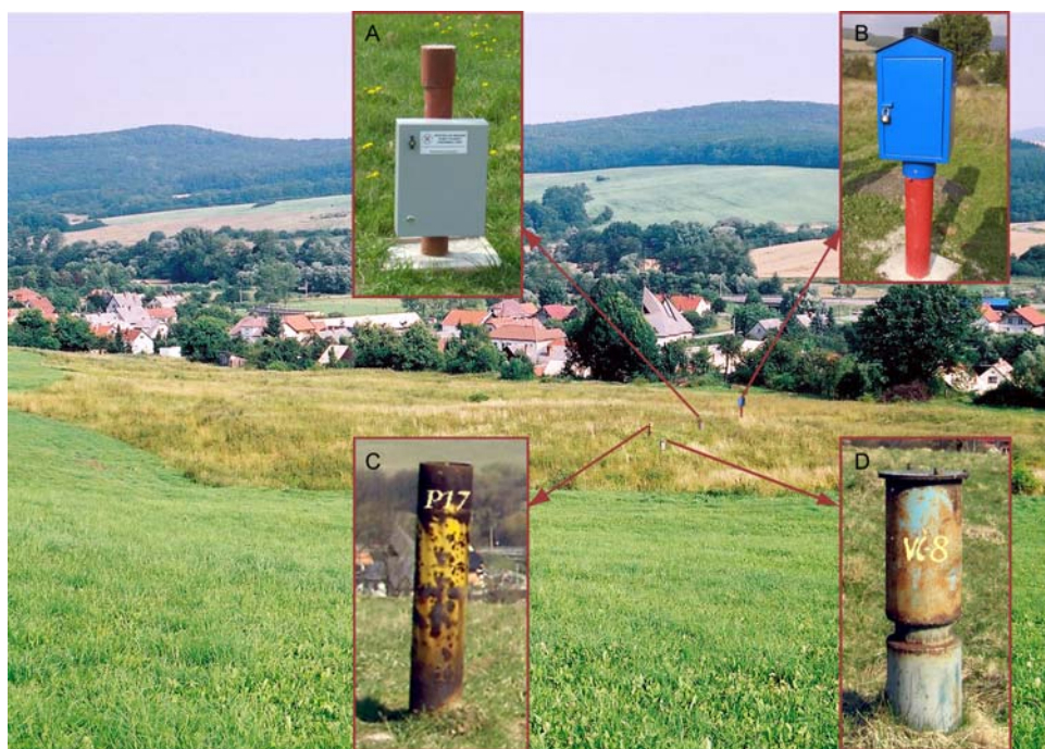
Zosuv nad obcou Veľká Čausa – pohľad od odľučnej oblasti na teleso zosuvu s niektorými monitorovacími objektmi: A – kontinuálny inklinometer umiestnený vo vrte KI-1, B – automatický hladinomer so systémom včasného varovania umiestnený vo vrte AH-1, C – geodetický bod P17, D – automatický hladinomer umiestnený v inklinometrickej vrte VČ-8 (foto P. Ondrejka).
