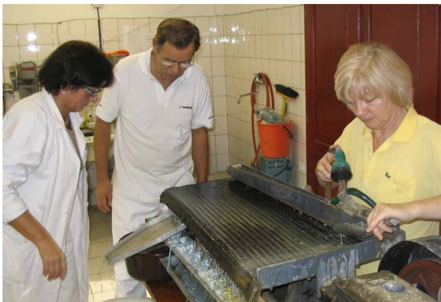
Pracovníci ATNS Košice Ľubica Kovaničová, Ľubomír Tuček a Mária Marčeková pri skúškach gravitačného rozdeľovania vzorky na koncentračnom stole mokrým spôsobom (foto Z. Németh).
