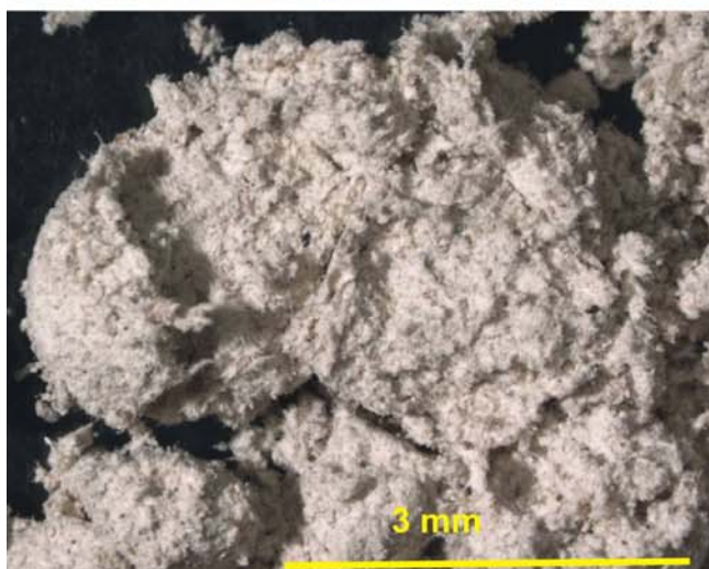
Aplikáciou sekvestrácie CO 2 s použitím materiálu eternitovej strešnej krytiny, ktorý je nebezpečným odpadom (hore) s prítomnými vláknami chryzotilového azbestu (v strede – šípky), sa úplne likvidovali nebezpečné vlákna (dole) (foto Z. Németh a P. Bačo).
