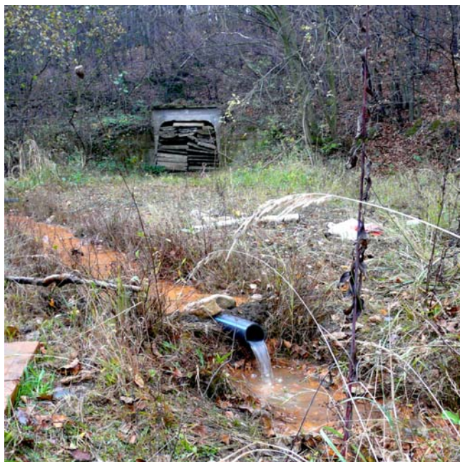
Dočasný merný profil na meranie okamžitej výdatnosti výtoku banskej vody zo štólne Budúcnosť, Pezinok (foto P. Bajtoš).
