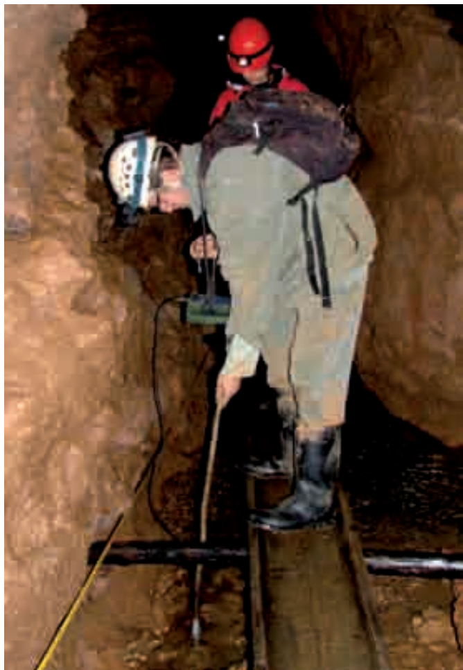
J. Švasta počas hydrogeologických meraní – termometrie a rezistivimetrie – aktívneho vodného toku v Krásnohorskej jaskyni. Foto: Eliška Cveková.
