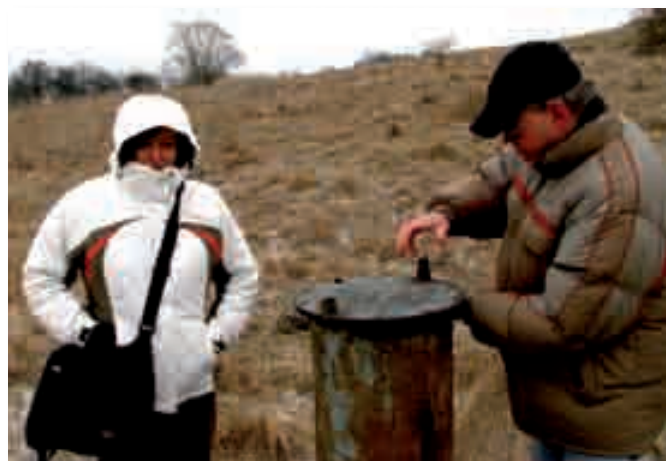
D. Magalová a P. Wagner pri príprave na odber údajov zaznamenaných automatickým hladinomerom vo vrte VČ-8 na lokalite Veľká Čauša. Foto: Peter Ondrejka.
