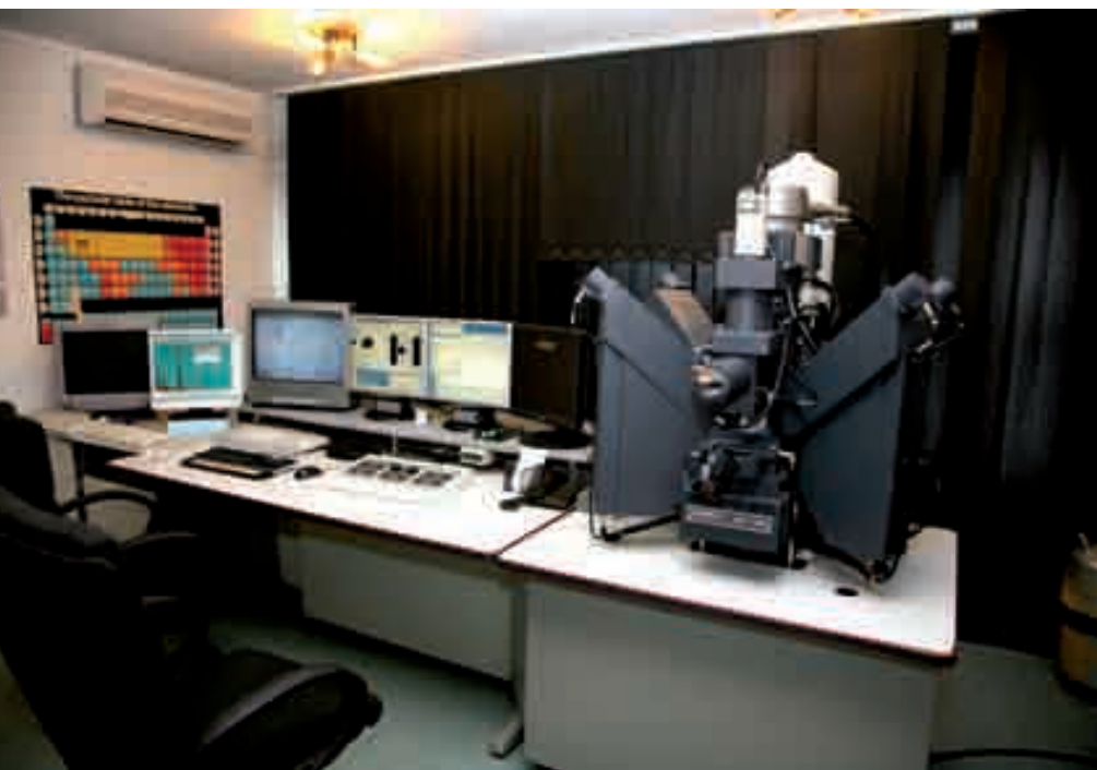
Elektrónový mikroanalýzátor CAMECA SX 100 v ŠGÚDŠ. Foto: Ladislav Martinský.
