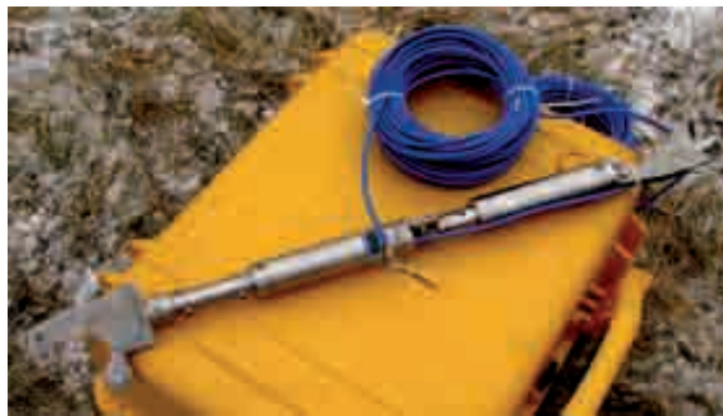
Kontinuálny inklinometer, ktorým sa priebežne zaznamenávajú deformácie na úrovni šmykovej plochy zosuvu – stav pred montážou do vrtu KI-1 na lokalite Veľká Čausa. Merania sa vykonávali v spolupráci s firmou Geoexperts Žilina. Foto: Peter Ondrejka.
