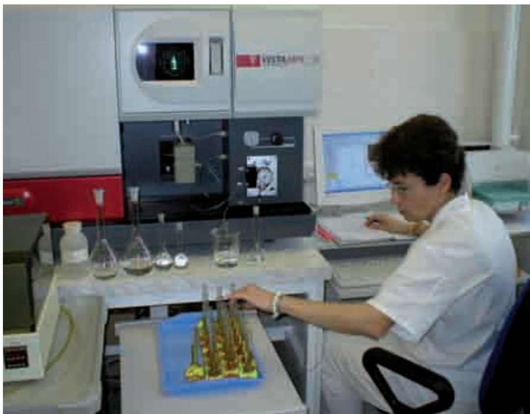
Stanovenie prvkov röntgenovo-fluorescenčnou spektrometriou (Ing. A. Majchrák) a atómovou emisnou spektrometriou s indukčne viazanou plazmou (RNDr. J. Nováková).
