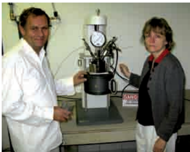
Reaktor PARR 4540 – Ing. L. Tuček a Ing. K. Čechovská pri optimalizácii procesu likvidácie CO 2 karbonatizáciou. Foto: Zoltán Németh.
