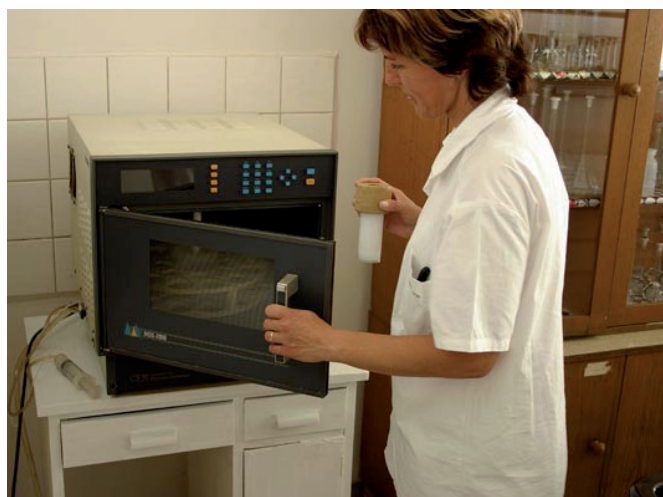
Mikrovlnný rozklad tuhých vzoriek (V. Kandriková). Foto: L. Martinský
