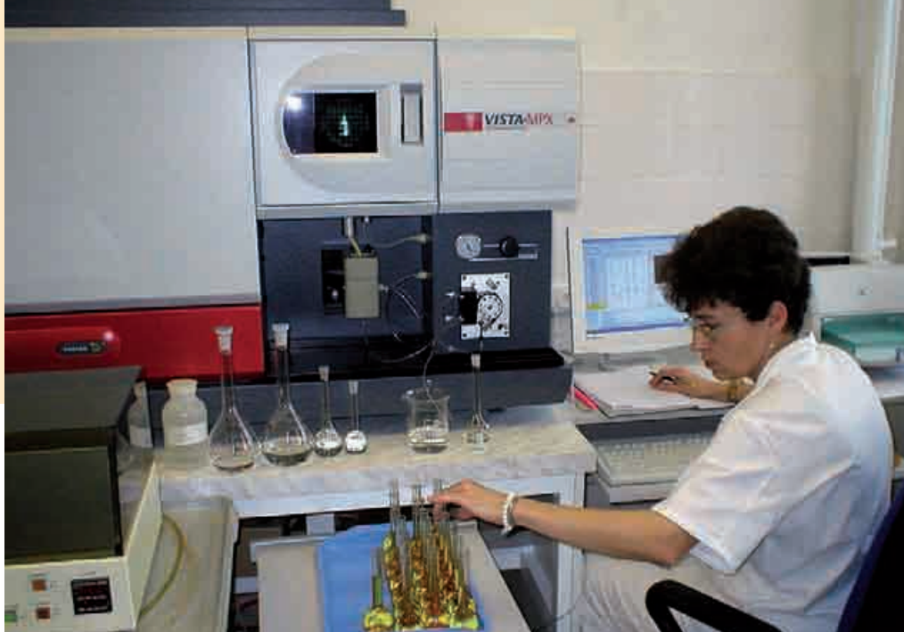
Stanovenie stopových prvkov metódou AES-ICP (J. Nováková). Foto: D. Mackových
