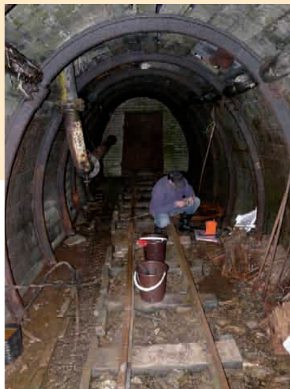
Príprava merania prietoku banskej vody v ústí štôlny Martin, Sb ložisko Dúbrava, Nízke Tatry. Foto: P. Bajtoš
