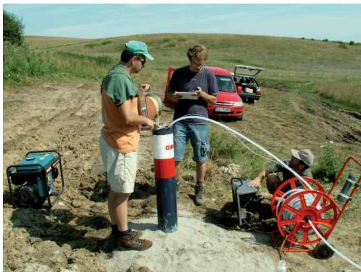
Realizácia krátkodobej čerpacej skúšky s konštantným znížením na vrte GOR-3. Foto: P. Bajtoš
