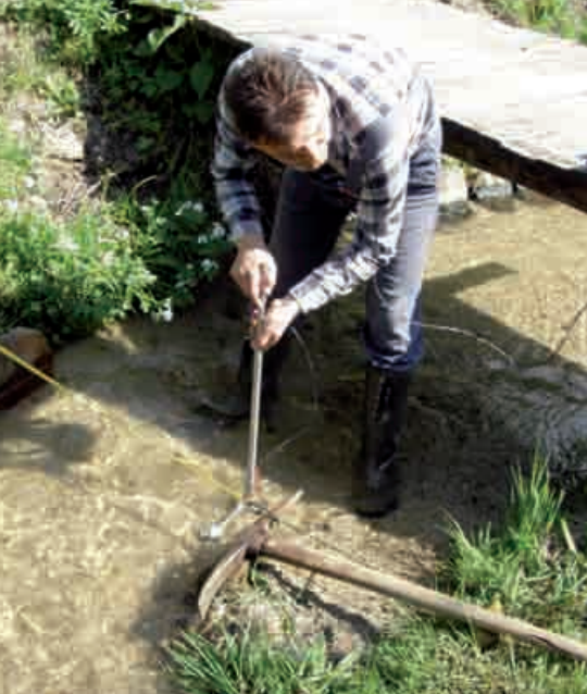
Mgr. Daniel Marcin vykonáva precízne merania prietoku hydrometrickou vrtulou v oblasti Veľkej Čausy v Handlovskej kotline. Foto: J. Michalko
