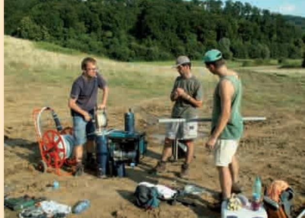
Meranie hladiny podzemnej vody vo vrte GOR-1 Foto: P. Bajtoš
