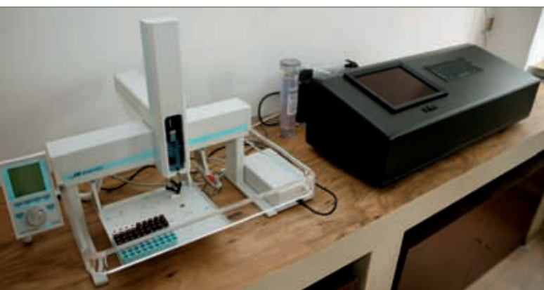
LWIA – laserový absorpčný spektrometer určený na merania izotopového zloženia vodíka a kyslíka vo vodách. Metodika meraní využíva technológiu OA-ICOS (Off-Axis Integrated Cavity Output Spectroscopy). Foto: L. Martinský
