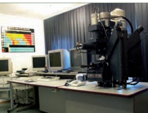
Elektrónový mikroanalýzátor CAMECA SX-100 v ŠGÚDŠ Bratislava.
