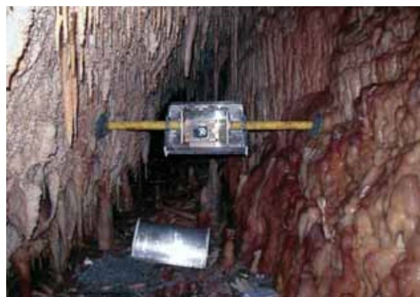
Dilatometer TM-71 inštalovaný v trhline v Čarovnej miestnosti Demänovskej Jaskyne slobody (Nízke Tatry).
