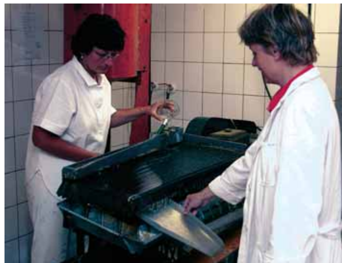
ATNS – regionálne centrum Košice – Ing. Katarína Čechovská a Ing. Ľubica Kovaničová pri gravitačnej separácii vzorky na koncentračnom splave. Foto: L. Martinský
