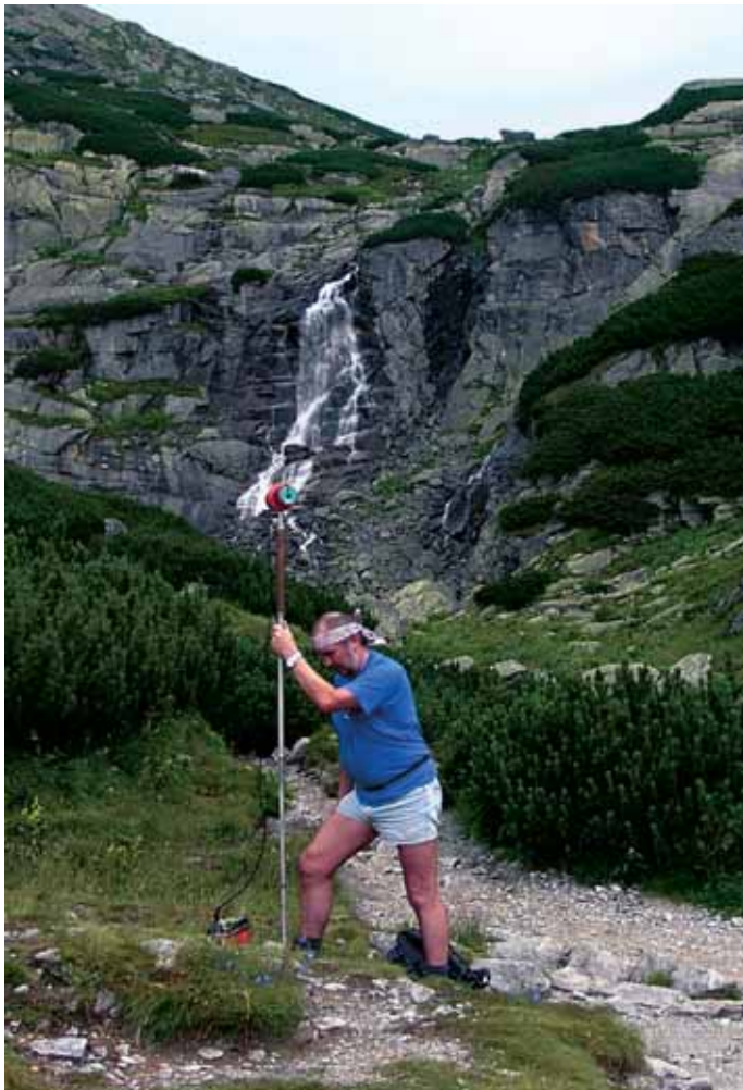
RNDr. Ľudovít Kucharič, CSc. – merania totálneho vektora magnetickej indukcie Zeme pod vodopádom Skok v Mlynickej doline. Foto: P. Kubeš
