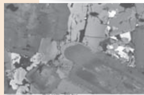
Plagioklasy (zonálne tabuľky), draselné živce (svetlosivé plochy) a kremeň (sivo-bielý) v kremitom diorite až monzodiorite, vrt KON-1, intruzívny komplex Banisko, Javorie (vzorka V. Konečného), obraz tvorený katódoluminiscenciou.
