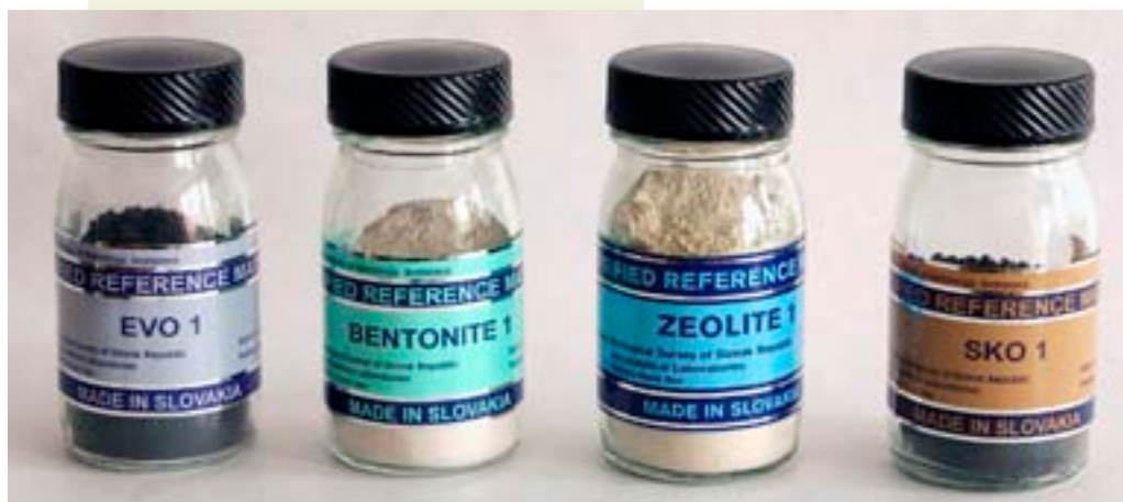
Certifikované referenčné materiály na kontrolu chemických meraní pripravené v GAL. Foto: L. Martinský
