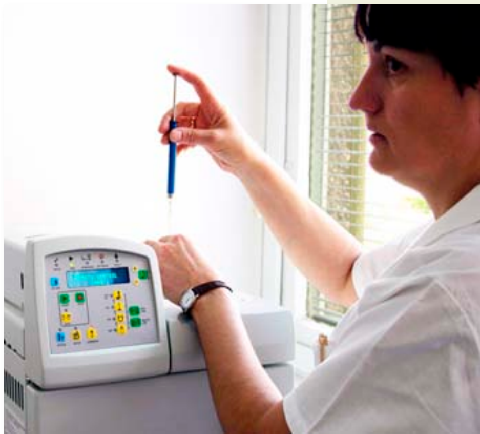
Analýza organických látok plynovou chromatografou (V. Luďvanská). Foto: L. Martinský
