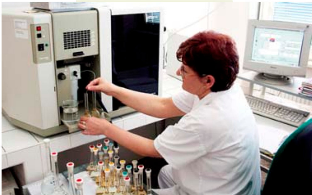
Stanovenie stopových prvkov metódou AAS (H. Ondíková). Foto: L. Martinský
