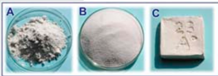
Kaolín: A – pôvodná vzorka kaolínovej suroviny, B – kremenný piesok ako vedľajší pro- dukt úpravy, C – keramické teliesko po výpale pripravené z výplavu pôvodnej vzorky. Foto: M. Repňák
