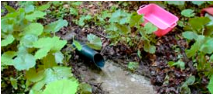
Hydrogeologické mapovanie – prameň pripravený na jednorazové meranie výdatnosti nádobou. Foto: P. Malík
