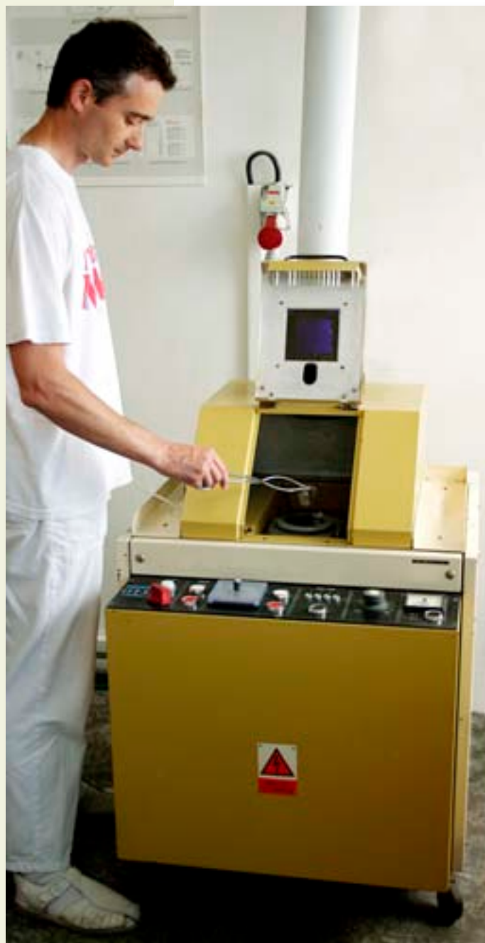
Príprava tavených perál pre stanovenie makroprvkov metódou RFS (A. Majchrák). Foto: L. Martinský
