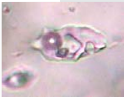
Fluidná inklúzia vysokej salinity s kryštálom halitu, porfýrovo-skarnové Cu ložisko Zlatno. Foto: P. Kodera
