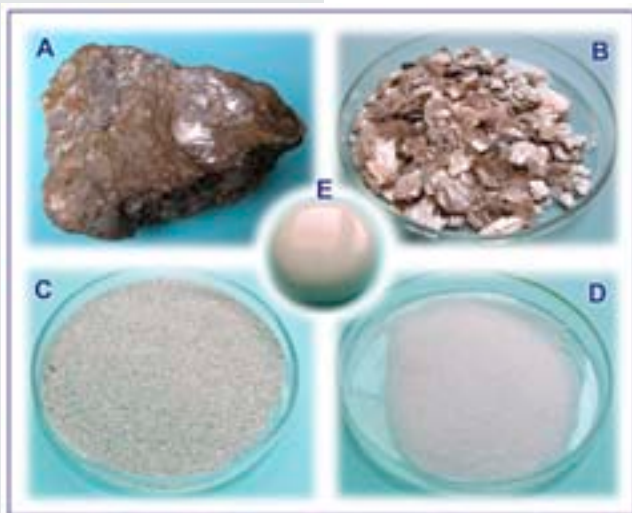
Živec: A – pôvodná vzorka živcovej horniny, B – sľadový produkt, C – živco- vý koncentrát, D – kremenný produkt, E – vypálené teliesko pripravené zo živcového koncentráту. Foto: M. Repňák
