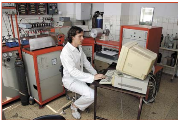
Mgr. P. Čech pri izotopovej analýze na hmotnostnom spektrometri Finnigan MAT – 250. Foto: L. Martinský Mgr. P. Čech performing the isotope analysis on the mass spectrometer Finnigan MAT – 250. Photo: L. Martinský
