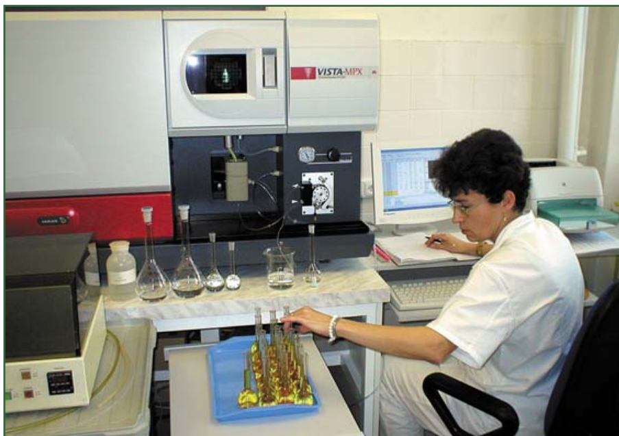
Simultánny atómový emisný spektrometer VISTA-MPX s indukčne viazanou radiálnou plazmou s CCD na stanovenie ultrastopovej koncentrácie prvkov vo vodách a tuhých materiáloch. Foto: P. Lučivjanský Simultaneous inductively coupled plasma atomic emission spectrometer VISTA-MPX with CCD for determination of ultratrace element concentration in waters and solid materials. Photo: P. Lučivjanský
