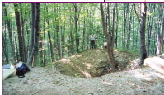
Ústie zavaleného vetracieho komína v banskom poli Šimonka, Dubník. Foto: P. Bajtoš The mouth of the caved-in ventilation funnel in the mining field Šimonka, Dubník. Photo: P. Bajtoš
