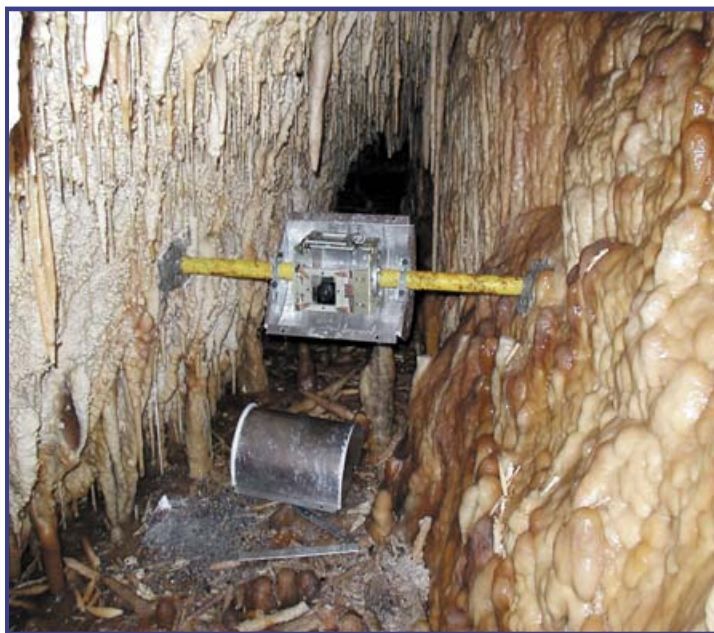
Projekt COST 625: Inštalácia mechanicko-optického dilatometra TM-71, Čarovná chodba, Demänovská jaskyňa Slobody. Foto L. Petro, august 2003 Project COST 625: Installation of the mechanic-optical gauge TM-71, Čarovná chodba, Demänovská jaskyňa Slobody. Photo: L. Petro, August 2003
