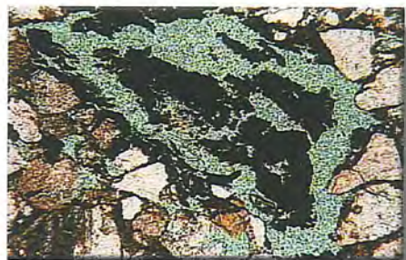
Optická porozimetria – vizualizovaná pórová sieť vo výbruse. Foto: A. Janega
