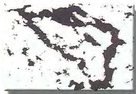
Optická porozimetria – snímka upravená na digitálnu analýzu obrazu, odstránené horninové pozadie, binarizácia. Foto: A. Janega
