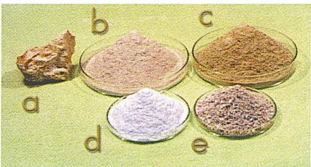
Slanská Huta: a) pôvodná vzorka brucitového vápenca, b) mletý brucitový vápenec pod 0,2 mm, c) produkt 1 = oxid horečnatý, d) produkt 2 = uhlíčitan vápenatý, e) produkt 3 = polovypálený produkt (PVP) tr. 1 - 4 mm pri 600 °C.
