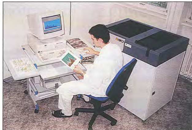
Práca na röntgenfluorescenčnom spektrometri Spectro X-LAB 2000
