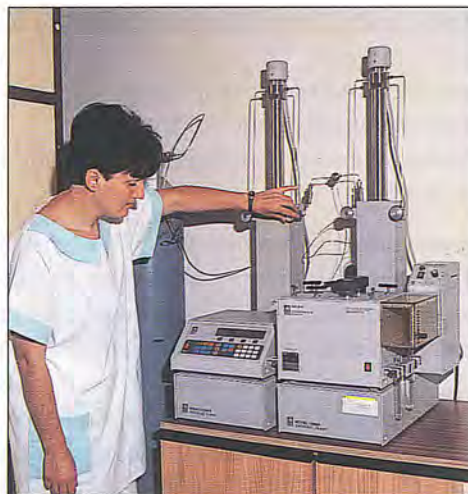
Moderná technika superkritickej fluidnej extrakcie – izolácia PAU zo streamsedimentov
