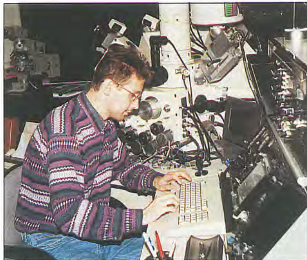
Práca operátora na elektrónovom mikroanalýzátore JEOL JXA-733 SUPERPROBE
