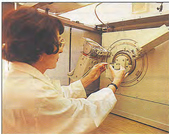
Príprava vzorky k röntgendifrakčnej analýze
