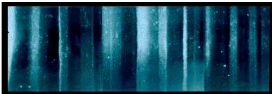
Obr. 6: 19 cm úsek ľadovcového vrtného jadra z projektu GISP ukazujúci „ročné“ vrstvy. Tento úsek pochádza z hĺbky 1,855 m a obsahuje 11 vrstiev so svetlejšími „letnými“ a tmavšími „zimnými“ vrstvičkami.
